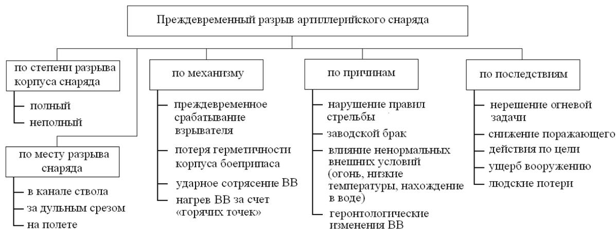
Рисунок 4 – Классификация случаев преждевременных разрывов снарядов
